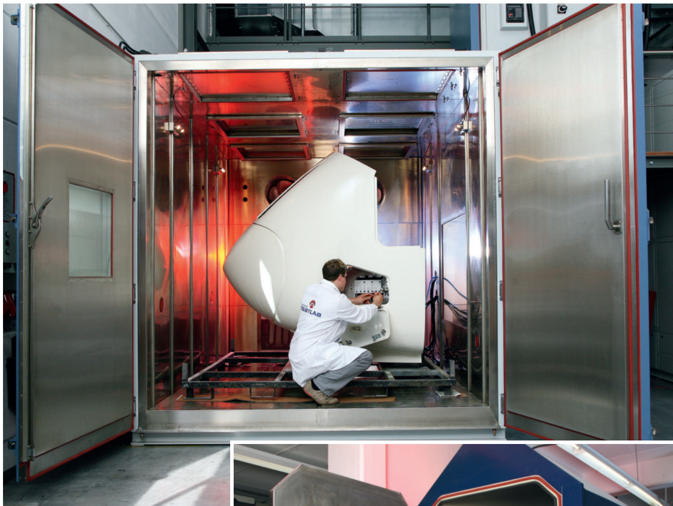
Bild 2. Prüfung einer Bugklappensteuerung in einer Klimakammer
