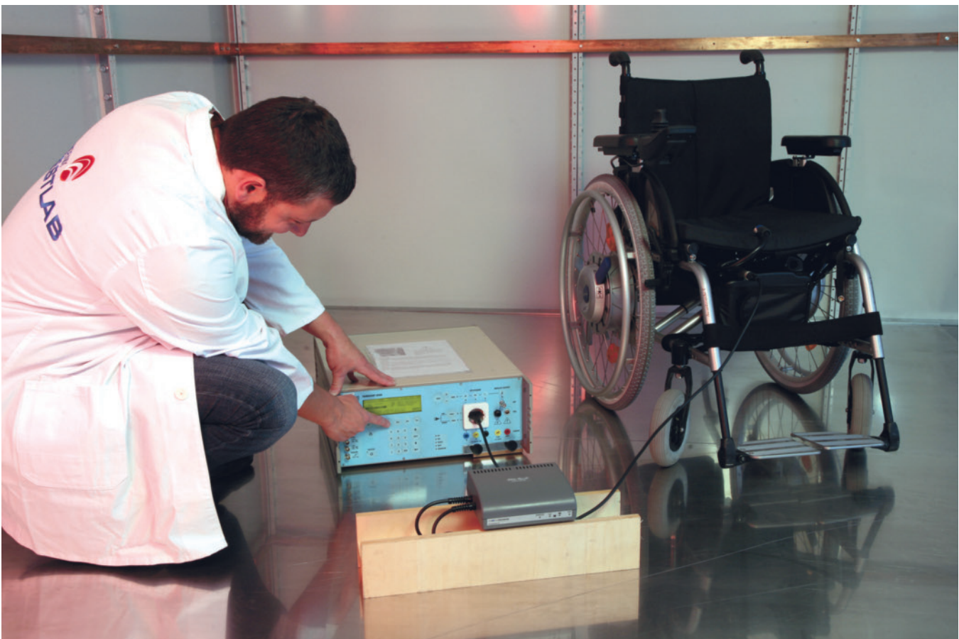
Bild 1. Prüfung eines Rollstuhls in einer Schirmkabine
